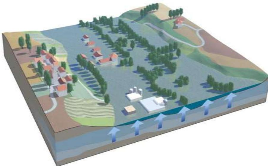
**Figure 17** : Schéma de principe d'une inondation par remontée de nappe [Source : [www.risquesmajeurs.fr](http://www.risquesmajeurs.fr) ]
