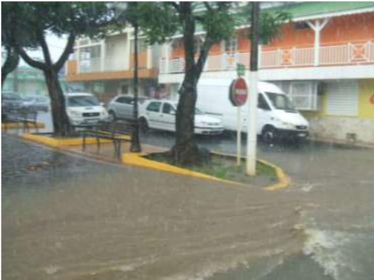
**Le ruissellement apparaîtra également dans les zones urbanisées** en raison de l'imperméabilisation des sols et des insuffisances du réseau pluvial [Fig. 22].
