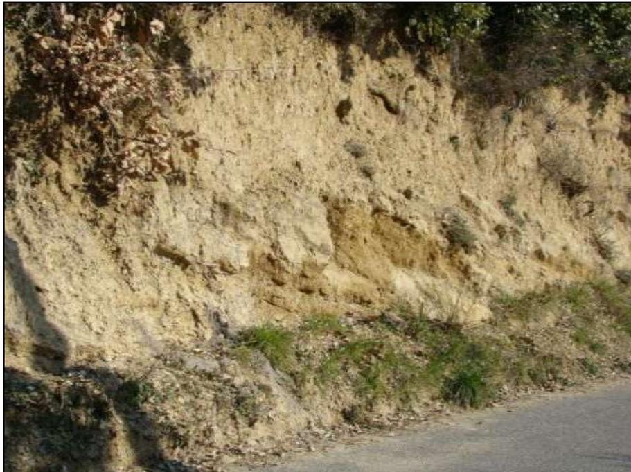
**Figure 8** : Affleurement de marnes sableuses du Miocène le long de la RD 216, en amont du cimetière
