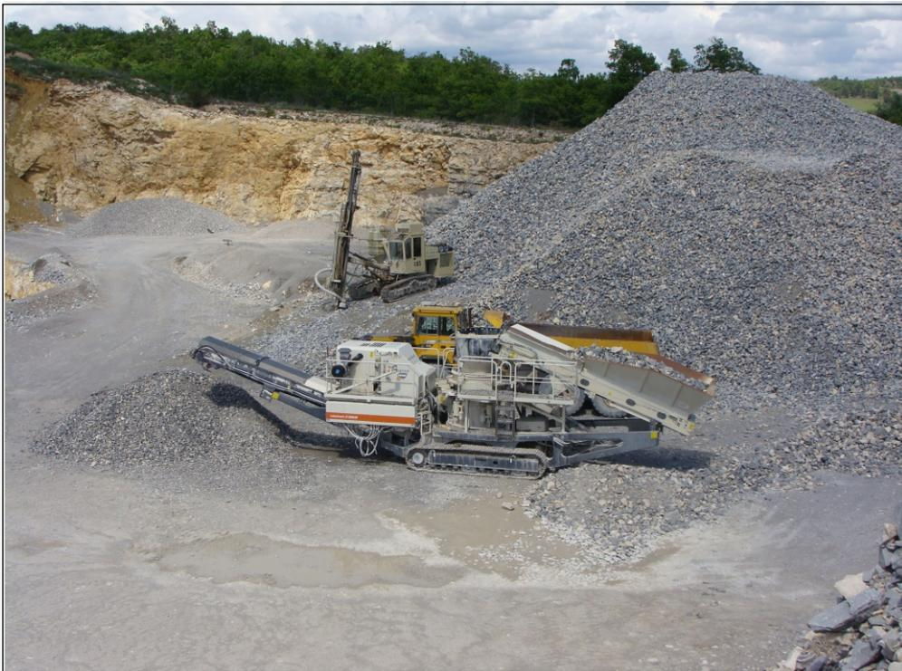
**Exemples de matériel de criblage-concassage mobile utilisé et foreuse**
