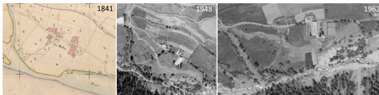
Illustration 14: A gauche, le cadastre napoléonien de 1841; au centre la photographie aérienne de 1948 où l'on peut observer un chenal d'écoulement à partir du gué en direction de la construction. A droite, la photographie aérienne de 1962, ultérieure à la crue de 1957, où l'on observe des traces de débordement au droit du hameau.
