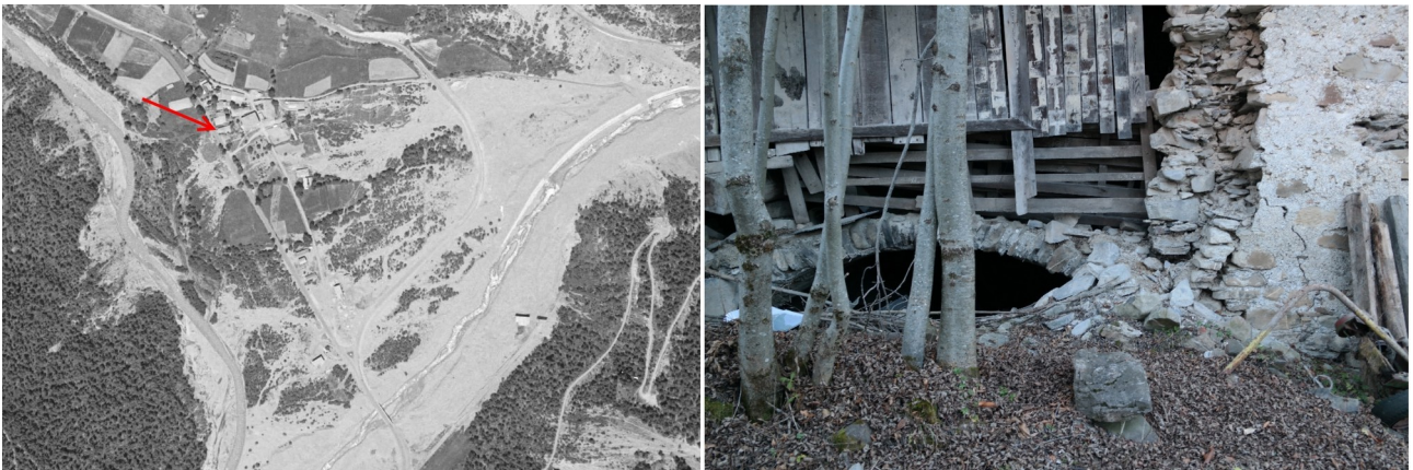
Illustration 10: A gauche, la photographie aérienne de 1962. A droite, le niveau de terrain actuel par rapport à l'ancienne entrée voûtée d'une construction du hameau (indiqué en rouge sur la photo aérienne). La hauteur comblée par les sédiments est d'environ 2 m. Il n'est pas certain que le comblement soit lié à la crue de 1957, il peut également être lié à une crue antérieure de l'Ubayette.
